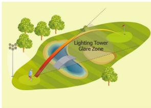
야간 골프장 조명 설계시 조명타워 위치 선정은 아주 중요합니다. 어느 위치에 조명타워를 설계하느냐에 따라 눈부심이 심할 수도 적을 수도 있습니다. 이 부분은 많은 조명시뮬레이션을 거쳐 최적의 자료를 찾아내는 것이 중요합니다. 고객이 자주 바라볼만한 지점에 조명타워의 조명이 고객을 비추고 있다면 당연히 눈부심을 느낄 수 밖에 없습니다. 이런 위치 선정은 많은 노하우를 가진 업체에서나 가능한 것이기 설계나 설치사제가 적은 업체가 조명타워를 위치를 설계하기는 어려움이 따르는 것입니다.
